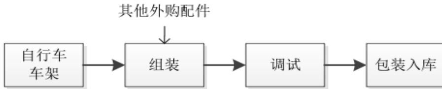
图 10-2 自行车自行车整车生产工艺流程图
